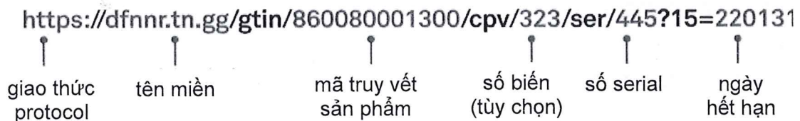
Hình 17 – Ví dụ về nội dung đường liên kết sau giải mã mã vạch QR Code
